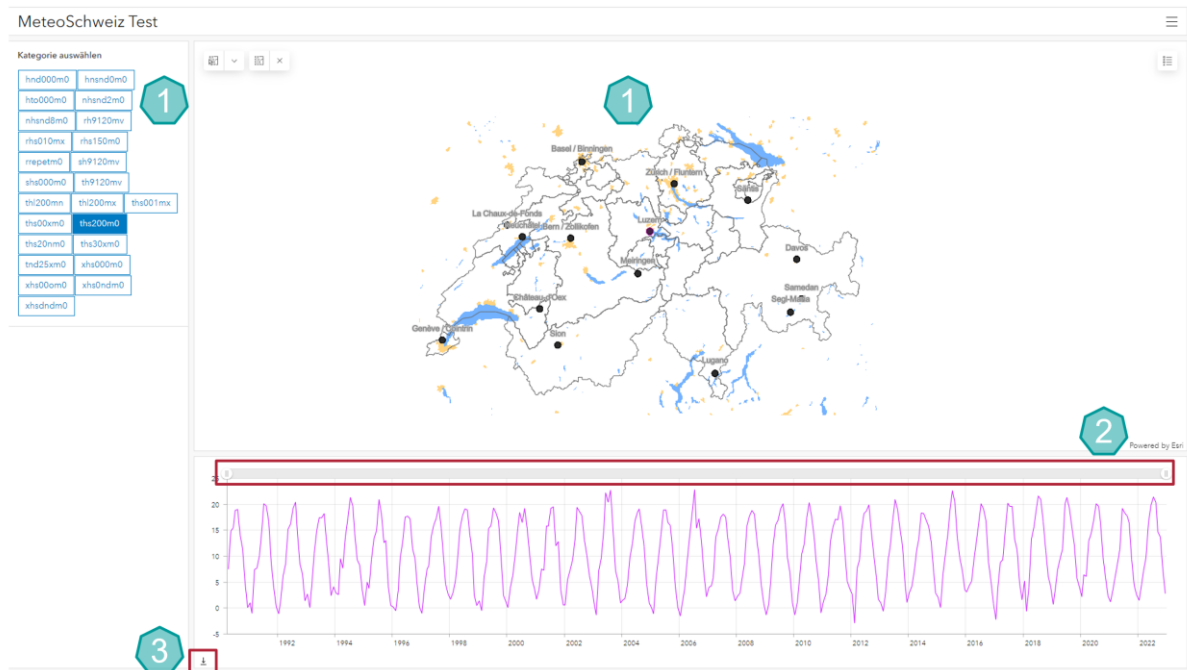
Abbildung 12: Kartenbasierter Prototyp eines Dashboards für Wetterstationsdaten mit interaktiver Variablen und Stationsauswahl (1), Zeitraumselektion (2) sowie Downloadfunktion (3).
